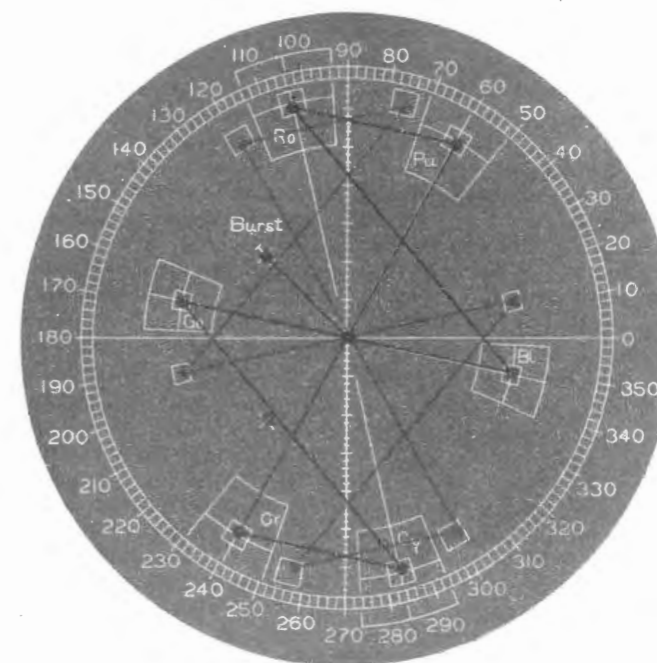
Fig. 4 - Relazioni di fase del segnale di crominanza per un'immagine di prova a barre colorate, viste al vettrosco.
