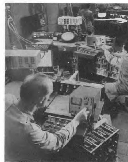
Il nuovissimo oscilloscopio portatile Philips PM 3200 viene impiegato per controllare l'assemblaggio dei componenti in una linea di montaggio di microscopi elettronici.
